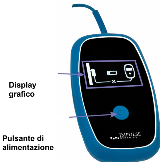
Figura 4: Caratteristiche del caricatore Vesta
