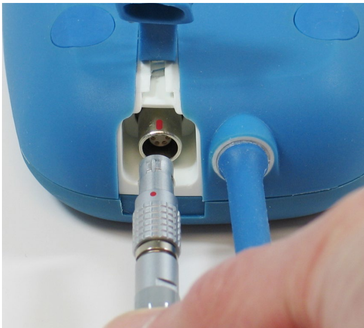
Figura 8: Allineamento dei connettori CC
