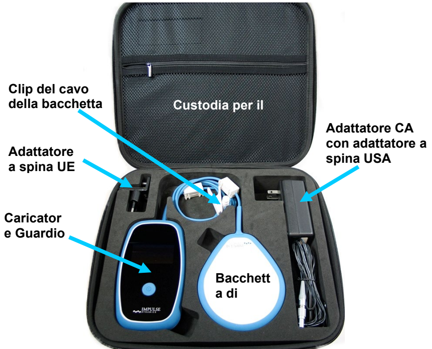
Figura 3: Componenti del sistema caricatore Vesta
