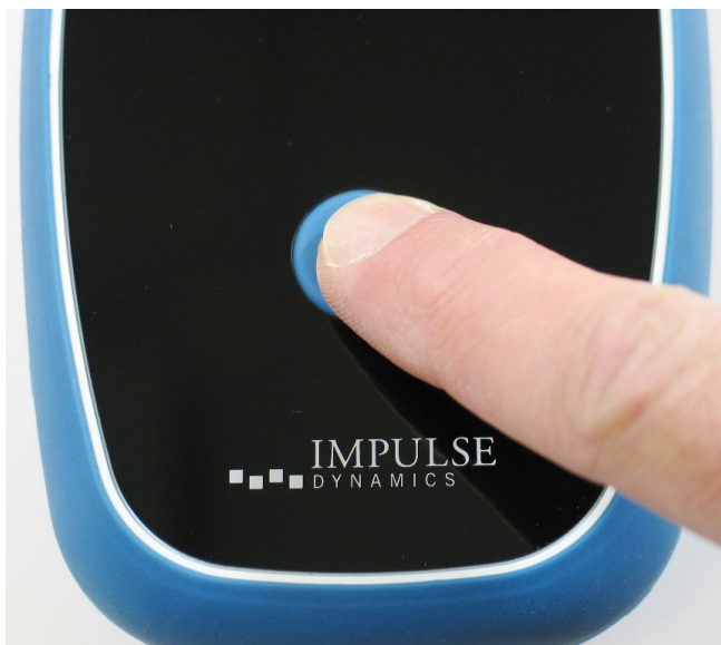
Figura 12: Pressione del pulsante di alimentazione sul caricatore
