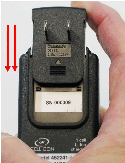
Figura 6: Installazione dell'adattatore a spina
