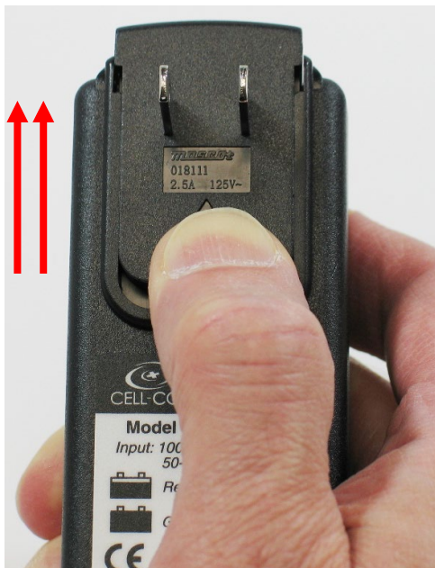
Figura 5: Rimozione dell'adattatore a spina
